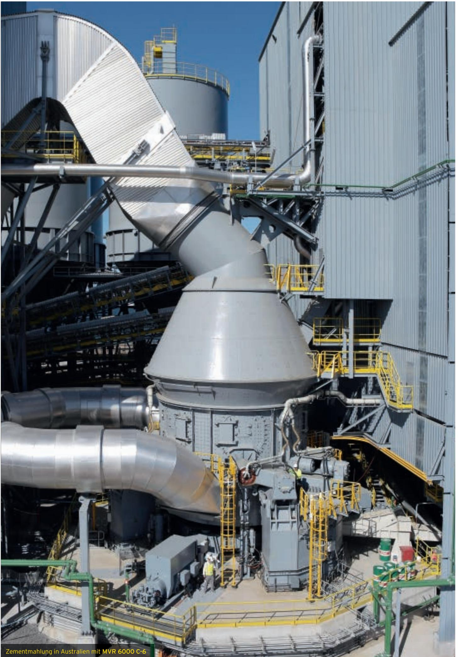
Zementmahlung in Australien mit MVR 6000 C-6
