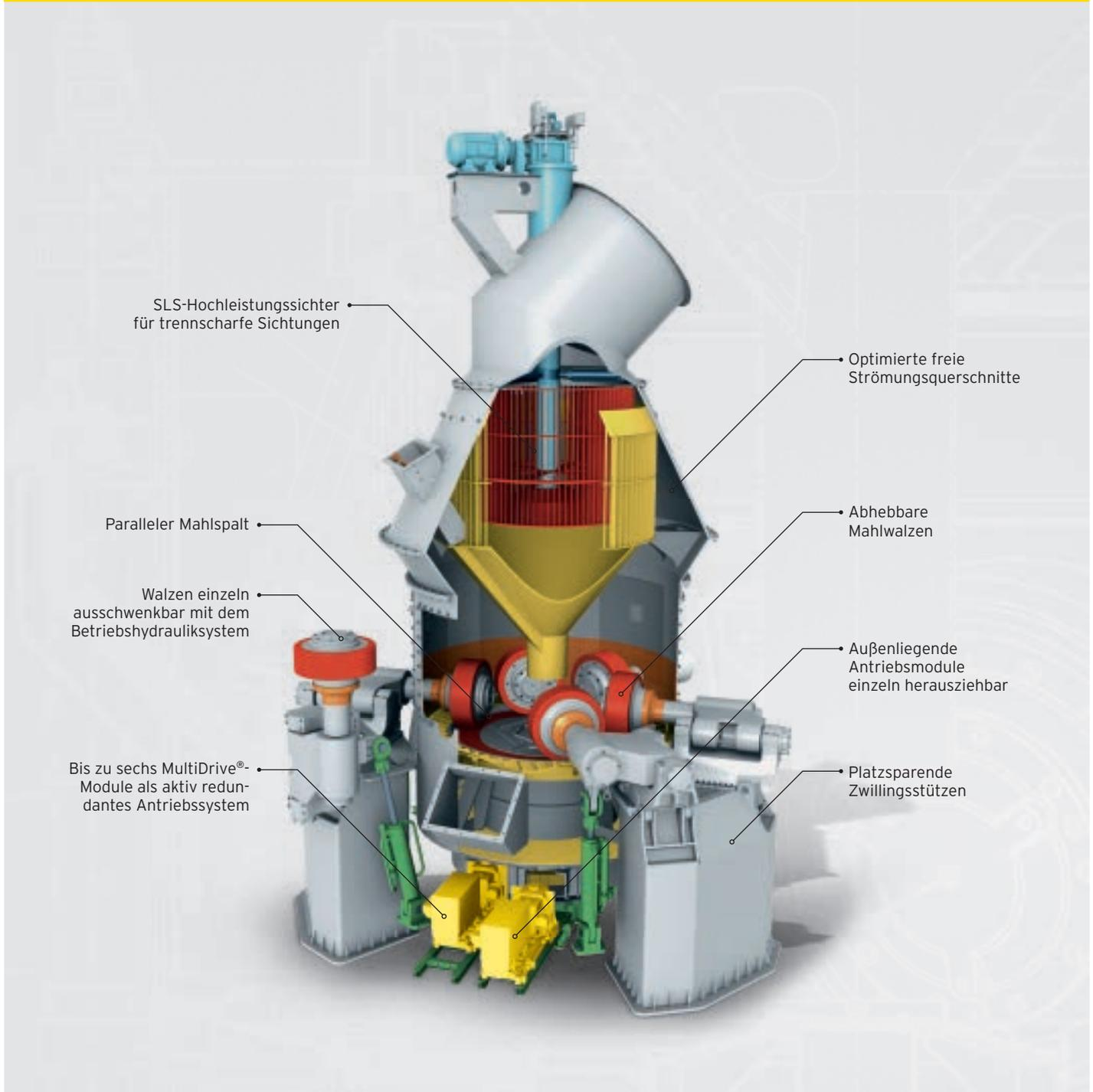
Die optimale Mühle für große Durchsatzraten. Sehr hohe Verfügbarkeit durch aktiv redundantes Walzen- und Antriebssystem (**MultiDrive®**), niedrige Verschleißraten und hervorragende Wartungsfreundlichkeit.
