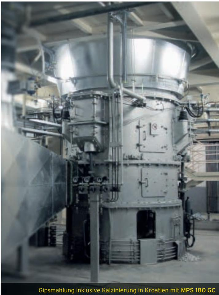
Gipsmahlung inklusive Kalzinierung in Kroatien mit MPS 180 GC
