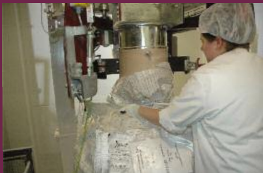
Manuelles Verschließen des befüllten Großsackes - optional durch unsere Tulpenbildung
