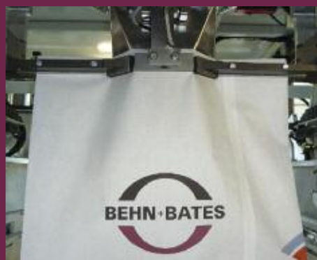
Produktgerecht: Die Sackbefüllung über den staubdichten Pulver- oder Klappentutzen
