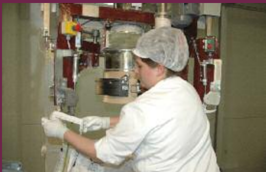
Einhängen der Großsack-Schlaufen in die schwenkbaren Haken
