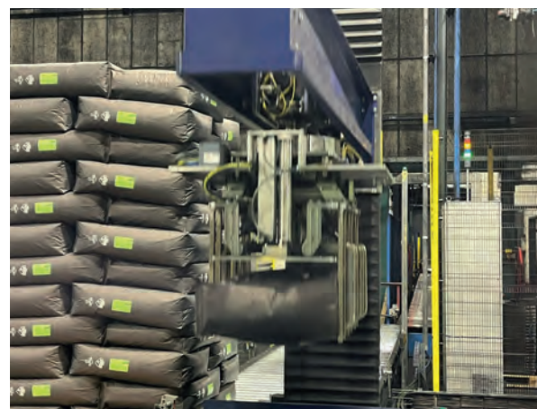
Afb. 7 Een palletiseerrobot stapelt de zakken.
