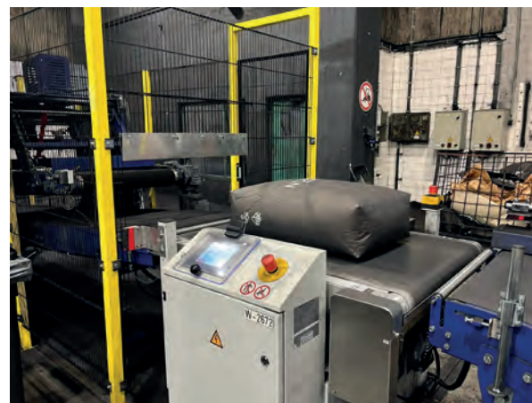
Afb. 6 Een afgevlude zak wordt gewogen.
