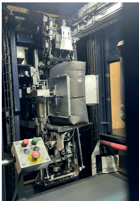
Afb. 4 Een ventielzak aan de vulmond van de verpakkingsmachine.
