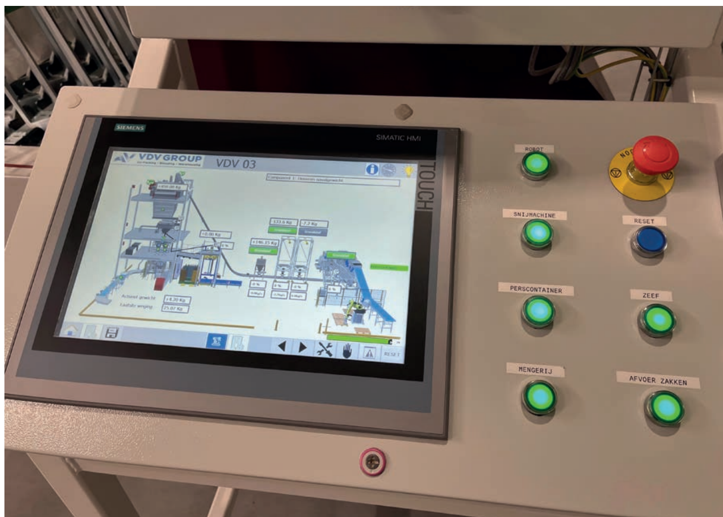
Afb. 4 Het bedieningspaneel met een grafische voorstelling van het proces.
